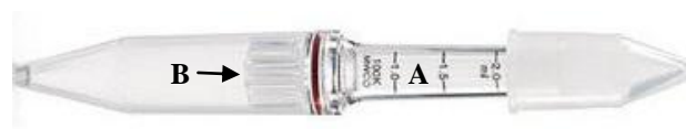
Figura 2. 2 - Tubo de purificação Vivacon®2 . A - Tubo de coleção A, capacidade até 2ml. B - Tubo de coleção B, capacidade de cerca de 100µl. ( http://www.directindustry.com/prod/sartorius-ag/centrifugal-concentrators-4963-520717.html )
