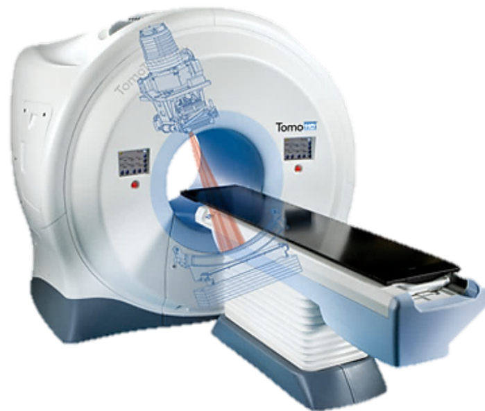
Figura 2.10: Equipamento típico de Tomoterapia. Constituído por um linac montado num anel e por uma cama móvel: o movimento da cama em conjunto com o do linac permite irradiar o tumor a partir de qualquer ângulo [Ogden, 2016].
