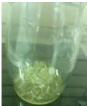
Figura 14: Cristais de sulfato de sódio deca hidratado
