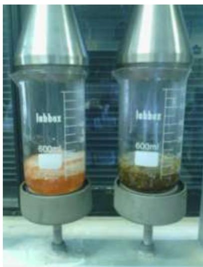
Figura 12: Digestão da amostra em “Fibertec”
