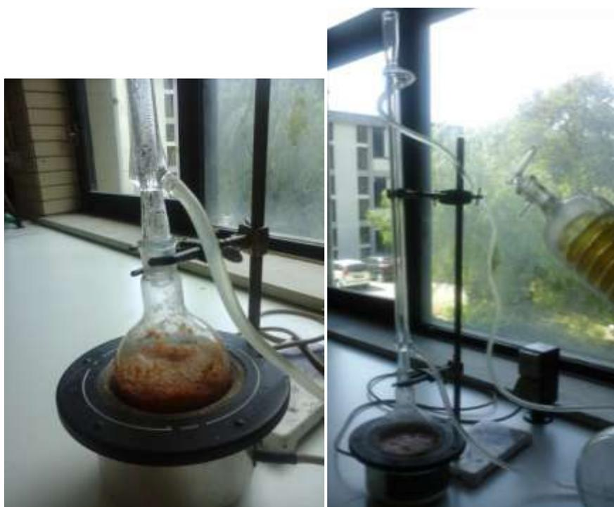
Figura 16: Sistema de extração/hidrólise sob ebulição em refluxo
