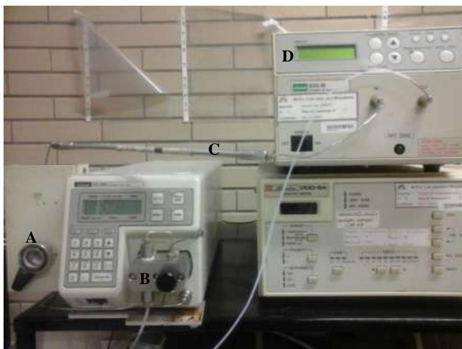
Figura 18: Constituição de um sistema de HPLC, **A)** sistema de injeção, **B)** a bomba, **C)** a coluna de separação e **D)** o detetor.
