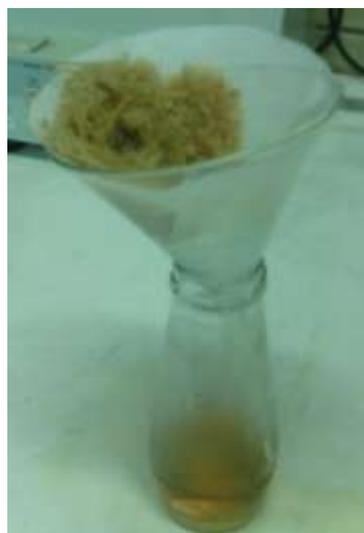
Figura 11: Filtragem do hidrolisado
