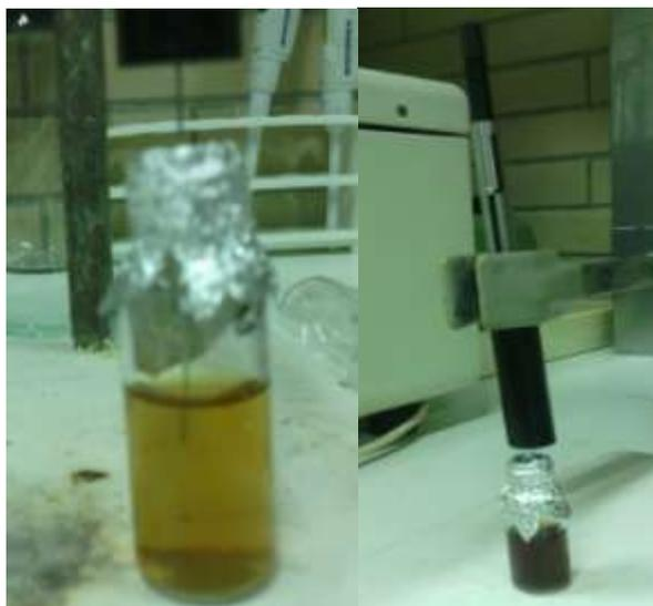
Figura 17: Método de micro extração na fase sólida (SPME)
