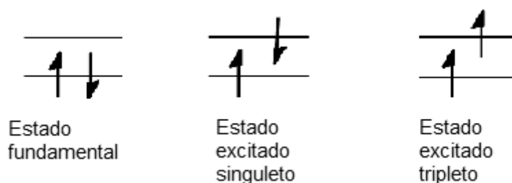
Figura 2.2. Representação do estado fundamental e dos estados excitados singuleto e tripleto de uma molécula 4
