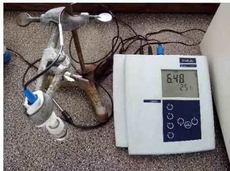
**Figura 2.4.** Medidor de pH InoLab da WTW.
