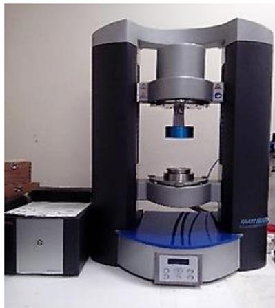
**Figura 2.3.** Reómetro Haake Mars, da Thermo Scientific.
