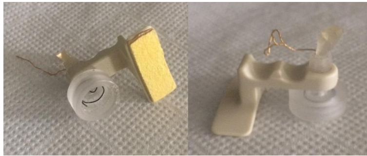
Figura 2.3. Sensor PEDOT-CNT desenvolvido para o registo eletroencefálico.
