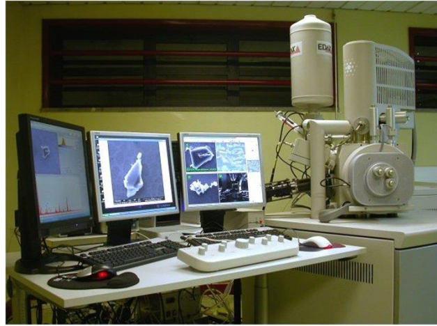
Figura 3.5. Equipamento Fei Quanta 400 FEG ESEM/EDAX Genesis X4M situado no Centro de Materiais da Universidade do Porto.
