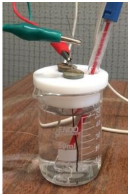
Figura 3.3. | Imagem da célula eletroquímica usada nos ensaios de caracterização dos elétrodos: EIS e CV 2 .
