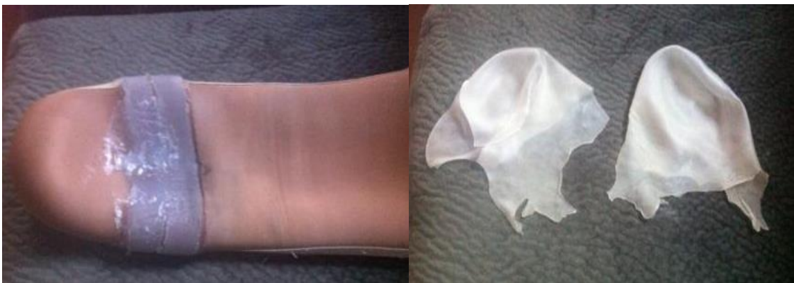
Figura 11 Interfaces elastoméricos degradados com a utilização: a) interface de copolímero de blocos e b) interface de gel de silicone.
