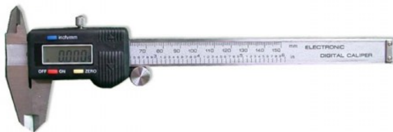
Figura 3.2.1. Craveira digital usada (sem marca relacionada ao produto).
