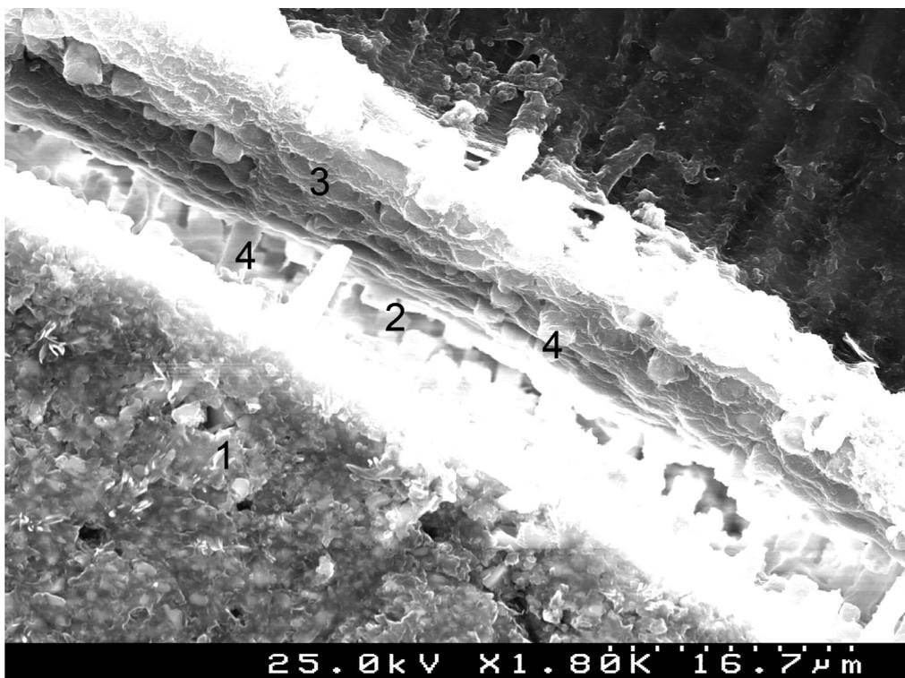
**Fig 27:** Imagem de MEV de uma zona de descolamento do grupo 3 evidenciando a resina de cimentação (1), a zona de descolamento (2) ao nível da zona híbrida (3) com “arrancamento” e fractura de alguns prolongamentos de resina que preenchem os tubulos dentinários (4).
