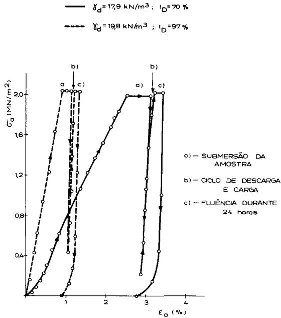
Fig. 9 — Ensaio de compressão unidimensional DU 50. Relação tensão-deformação para diferentes estados de compactação
