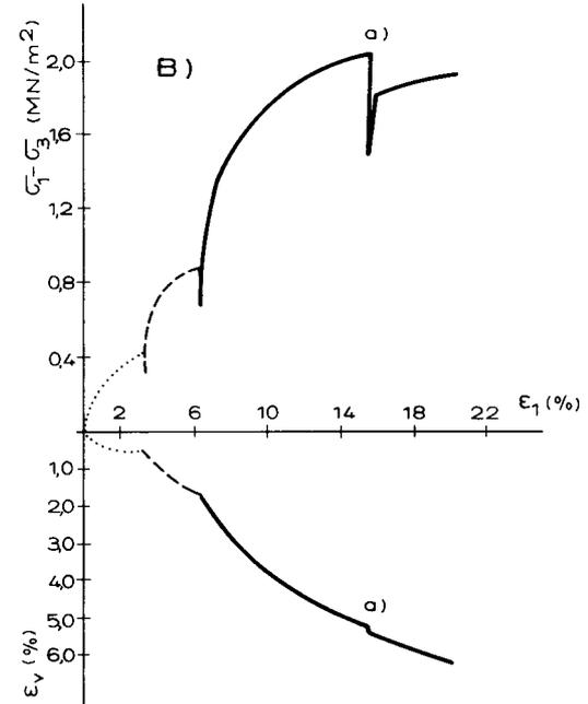
Fig. 7 — Ensaio triaxial. Relação tensão-deformação do enrocamento com: A)  $I_D = 97$ ; B)  $I_D = 70\%$
