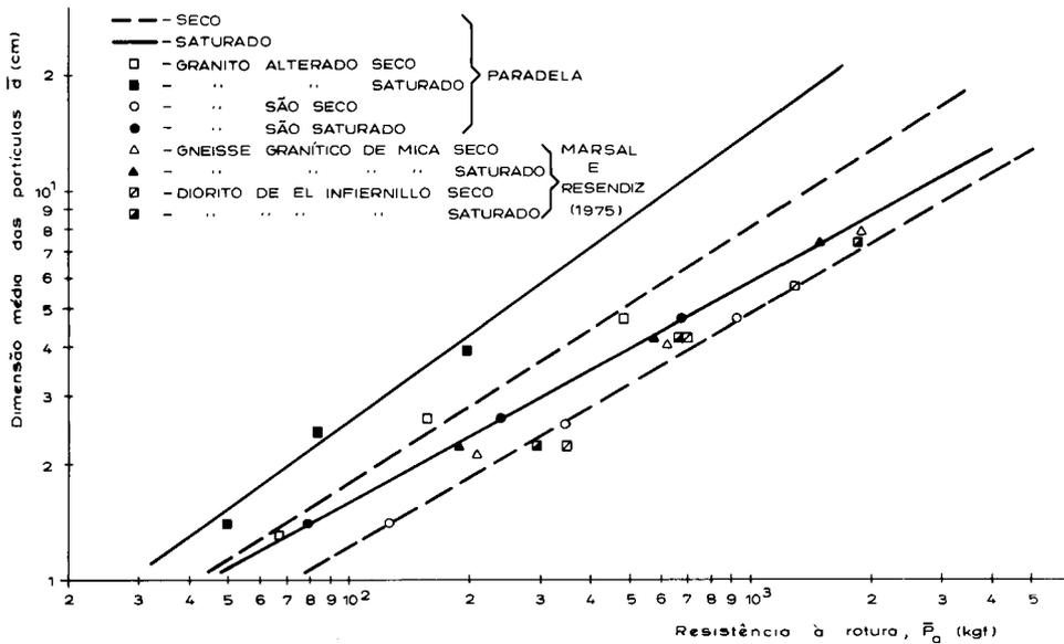
Fig. 2 — Resistência ao esmagamento, versus dimensões das partículas
