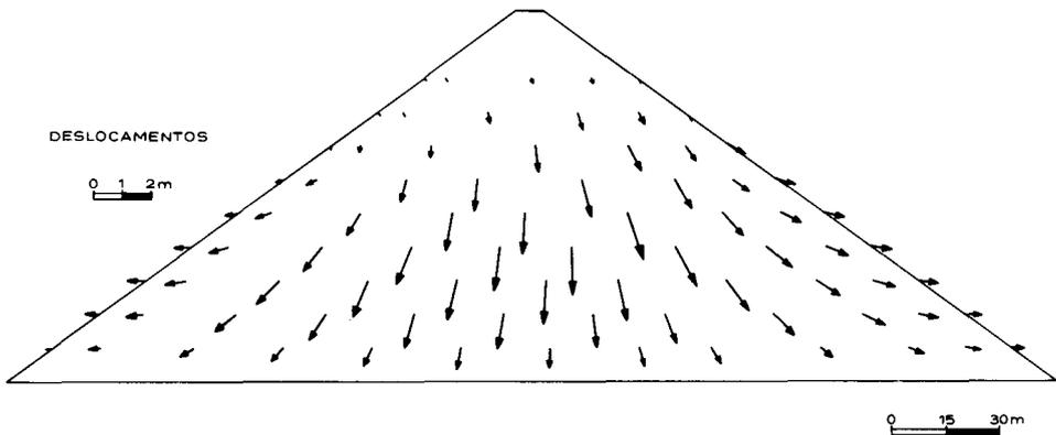
Fig. 12 — Simulação da construção por camadas horizontais.  $I_D = 70\%$
