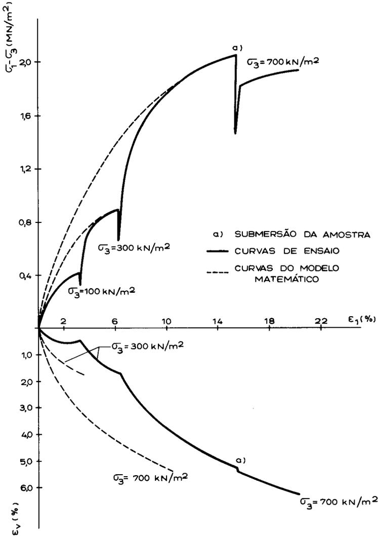
Fig. 10 — Extrapolação do início das curvas tensão-deformação
