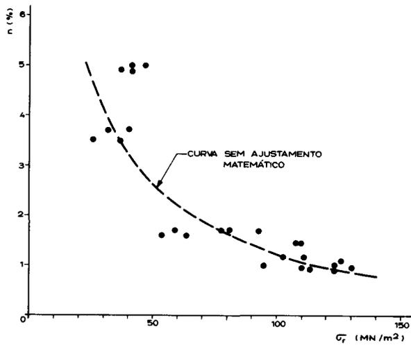
Fig. 4 — Compressão simples. Variação da resistência à rotura com a porosidade
