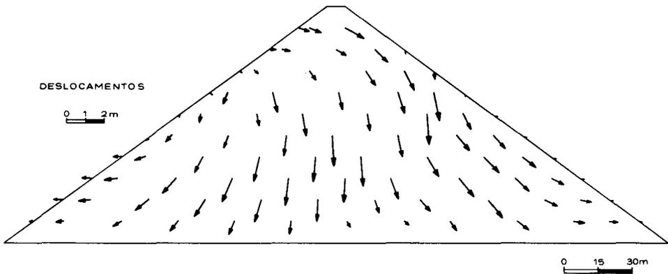
Fig. 11 — Simulação da construção por fases.  $I_D = 70\%$
