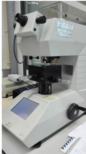
Figura 6 – Dispositivo HMV-2 SHIMADZU.
