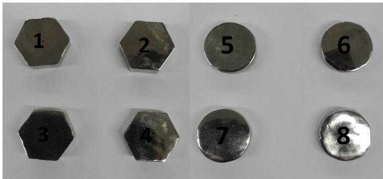
Figura 1 - Amostras maquinadas (1- 4) e fundidas (5 - 8).
