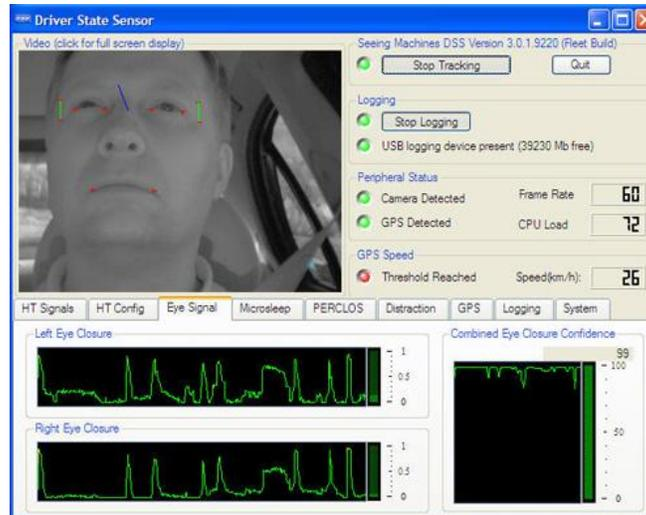
Figura 8: Detecção de sonolência através da análise de *Eye Tracking* (Software Drive State Eléctrodo [57]).
