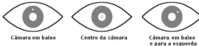
Figura 7: Várias posições da câmara por forma a perceber a percepção da pupila em relação à reflexão da córnea [60].
