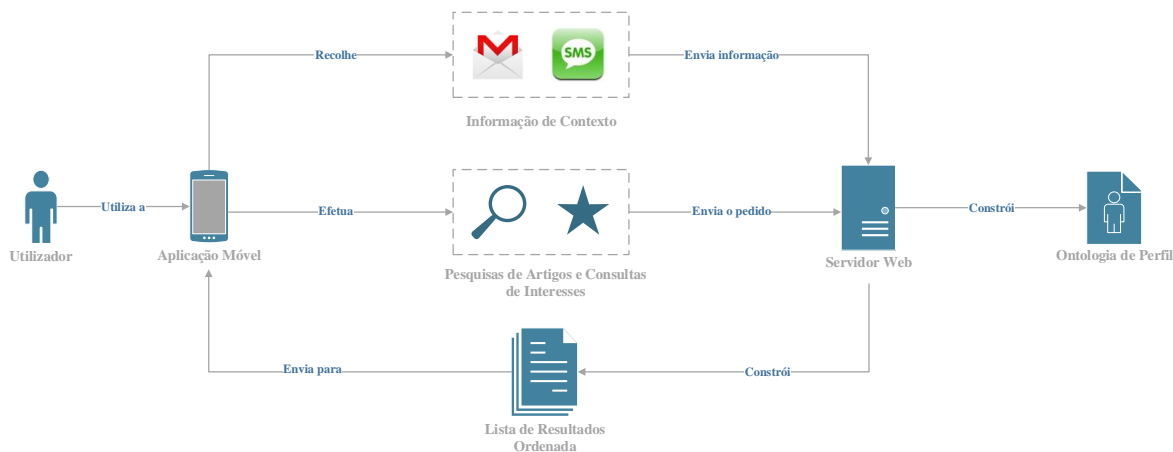
Figura 3.1: Visão geral do funcionamento do sistema MSCS.
