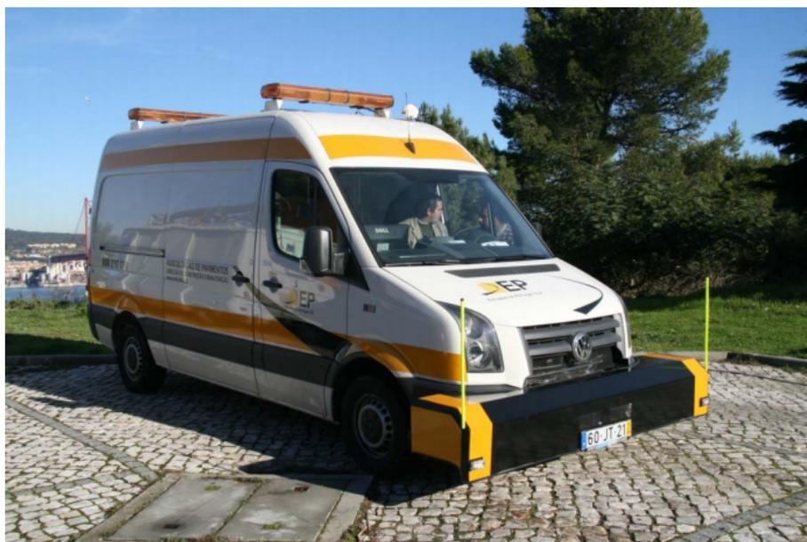
Figura 10: Perfilómetro Laser
