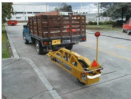
Figura 13: Perfilómetro Inercial
