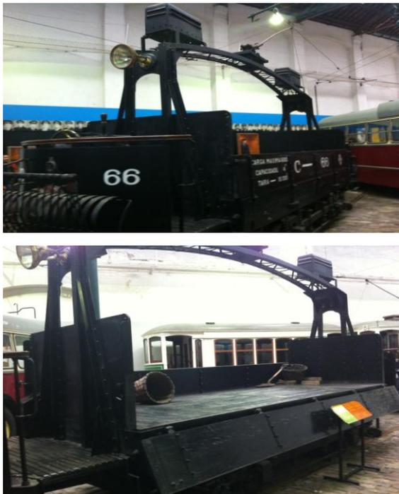
Este tipo de carro elétrico era utilizado, fundamentalmente, para o transporte de carvão e mercadorias. Foi construído nas oficinas da Companhia Carris de Ferro do Porto em 1915.
