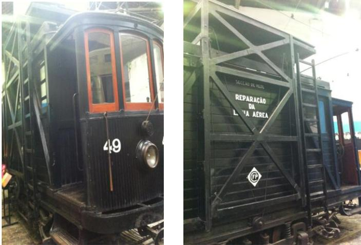
Este carro elétrico, munido de uma plataforma de elevação manual, servia para reparar as linhas aéreas e os carros elétricos que se encontravam a laborar nas ruas da cidade do Porto. Foi construído pela Companhia Carris de Ferro do Porto em 1932.
