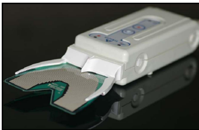
Figura 1. Sensor e adaptador do sistema de análise oclusal T-Scan® III HD.
