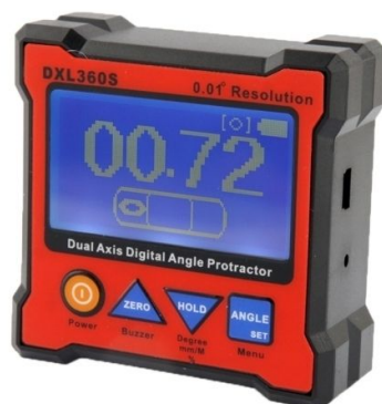
Figura 7. Exemplo de um dos inclinómetros adquiridos e instalados na mesa de ensaios.
