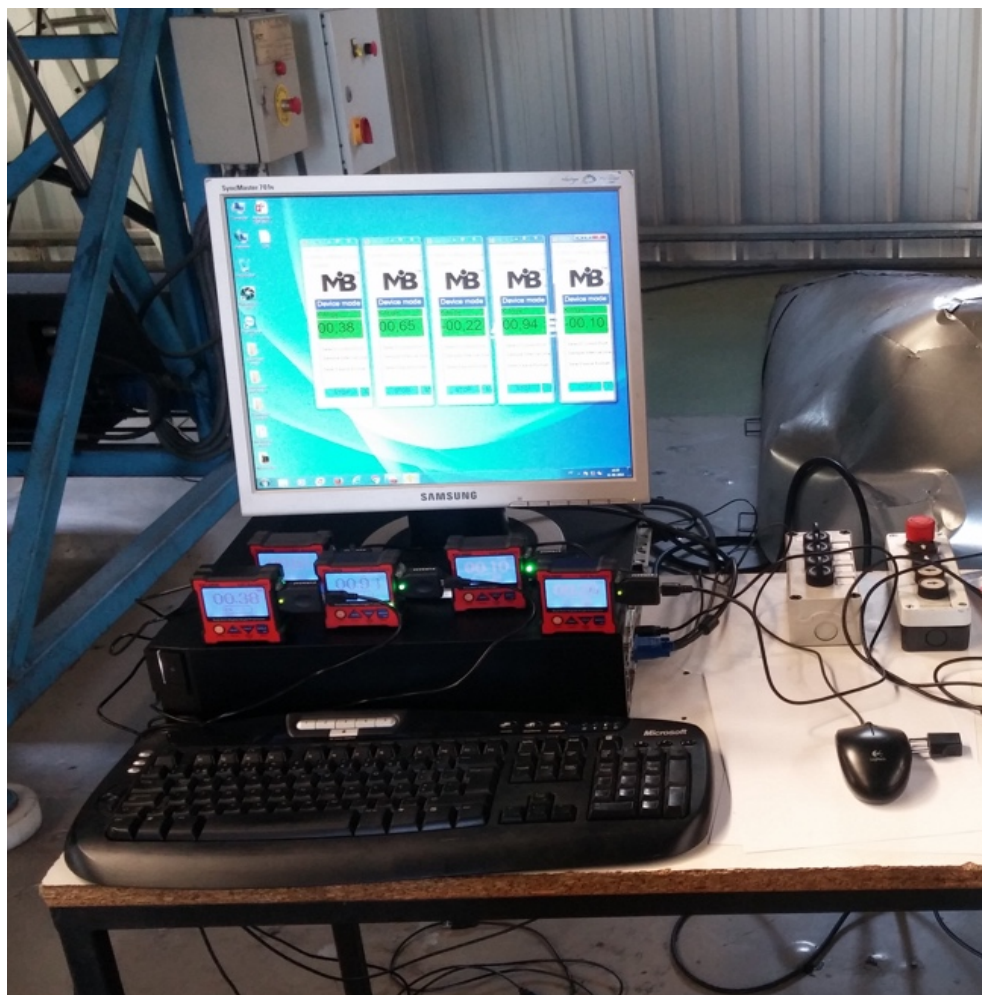
Figura 8. Inclinómetros conectados ao computador e respetiva interface.
