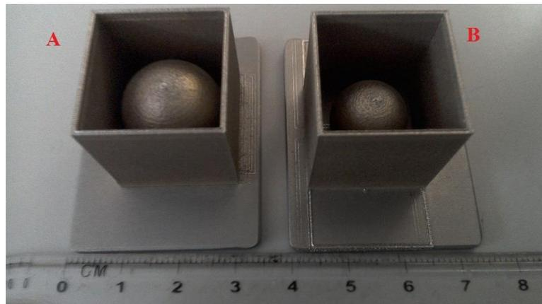
Figura 3.11. Esferas com cubo produzidas por fusão seletiva por laser.
