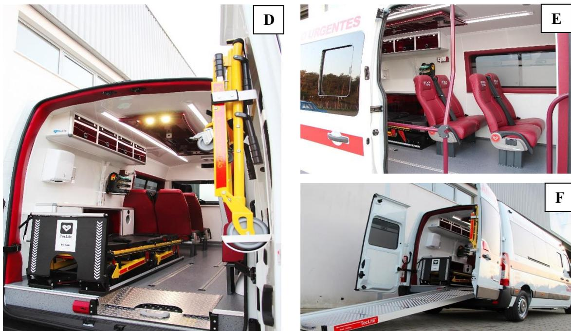
**Figura 2.4** – As imagens D, E e F representam uma viatura de tipologia A2/ABTM, transformada na TecLife.
