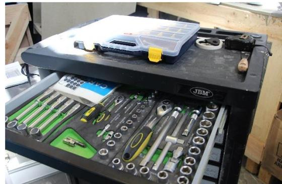
**Figura 4.10** - Aspeto do carro de ferramentas após uma intervenção baseada na prática 5S.
