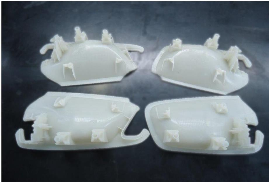
**Figura 3.11** Peça do M1775 com defeitos de compactação.
