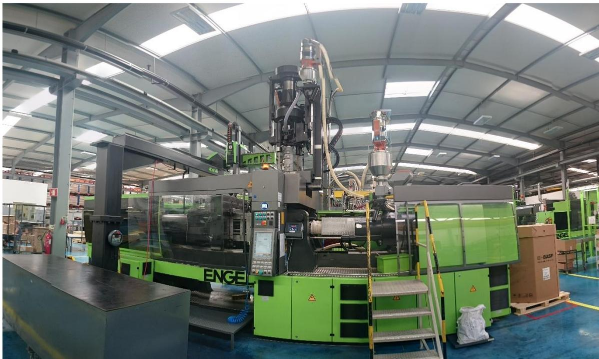
**Figura 3.25** Máquina de injeção Engel, usada nos testes do M1775.
