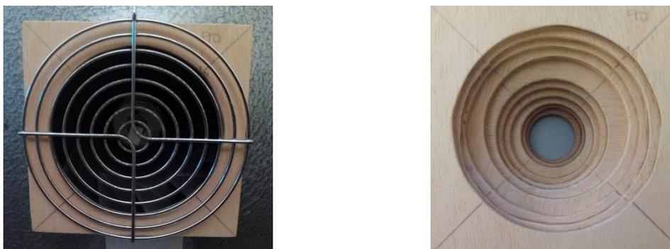
**Figura 3.3.** Placas de madeiras limitadoras do diâmetro de aspiração do ventilador.
