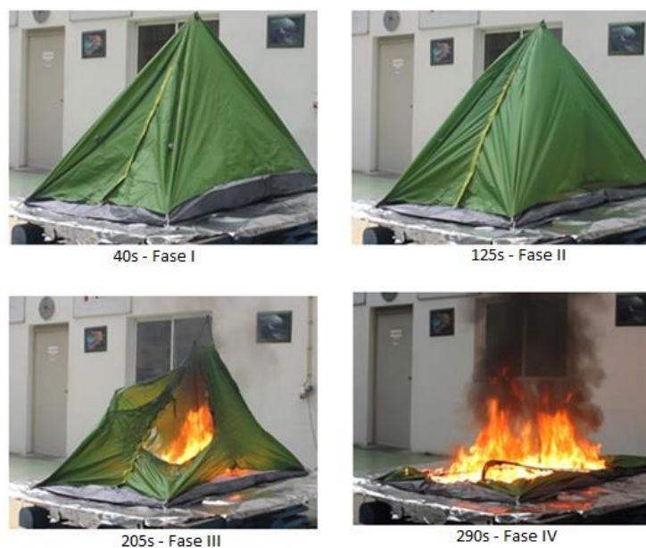
Figura 4.18. Fases representativas da variação de massa, Ensaio 3.
