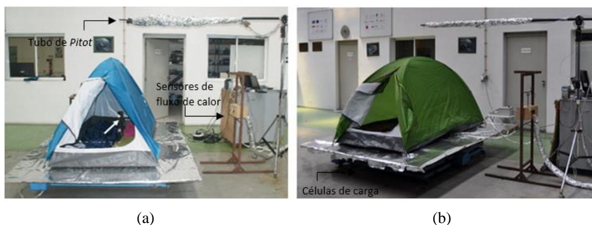
Figura 3.3. Esquemas dos ensaios das tendas (CEIF/ADAI).
