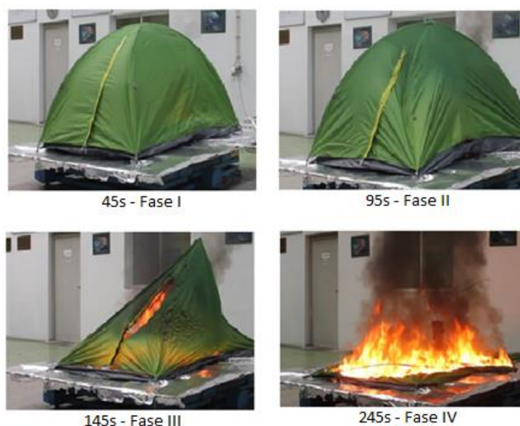
Figura 4.11. Fases representativas do gráfico de variação de massa, Ensaio 2
