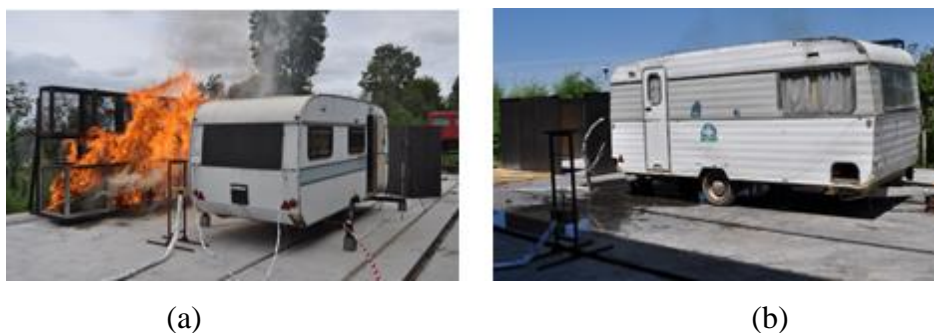
Figura 3.6. Sensores de fluxo de calor refrigerados a água: (a) Ignição no exterior; (b) Ignição pontual no interior (CEIF/ADAI).
