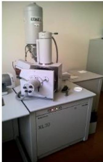
**Figura 3.15** - Microscópio eletrónico de varrimento Philips XL 30.
