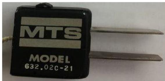
Figura 3.12 - Extensômetro Instron MTS, utilizado.
