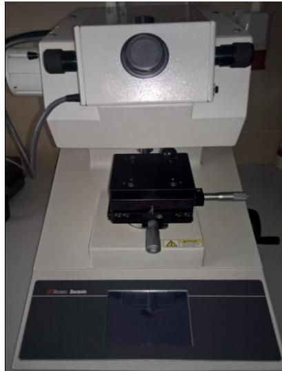
**Figura 3.4** - Equipamento Struers Duramin I, usado para cálculo de durezas.
