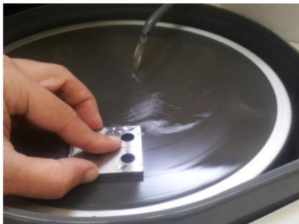
Figura 3.2 - Prato utilizado para o polimento dos provetes.
