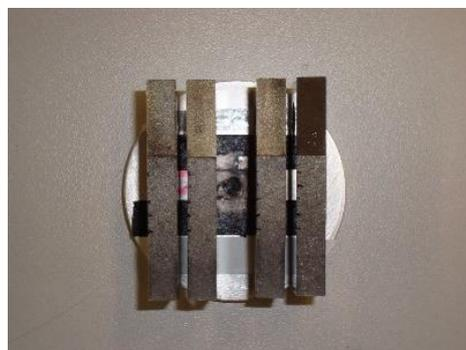
**Figura 3.16** – Vista de topo da montagem para análise da superfície de fratura.
