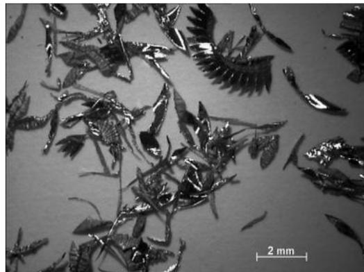
Figura 5- Micrografias das aparas do cobre puro.
