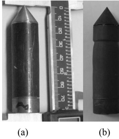
**Figura 13- (a) Tubo antes da compactação; (b) Tubo após compactação.**
