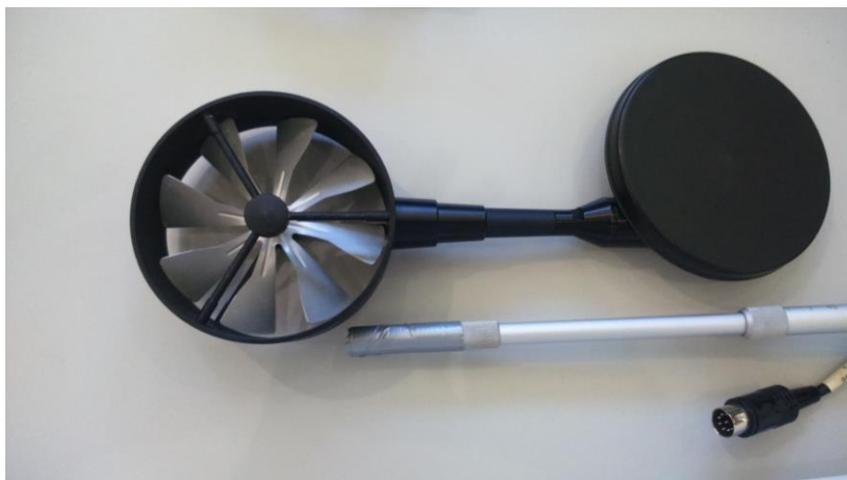
Figura 3-11. Anemómetro de hélice.
