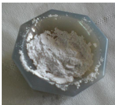
Figura 24 – Almofariz com mistura do pó com sulfato de bário.
