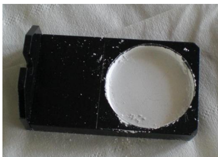
Figura 25 – Material prensado e pronto para análise de transmitância.
