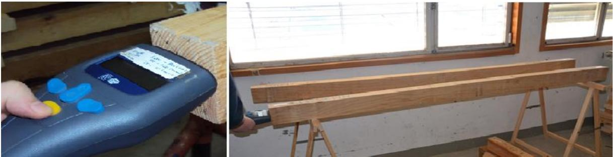
Figura 4.1 – Medição da frequência própria de vibração através do *Timber Grader* MTG
