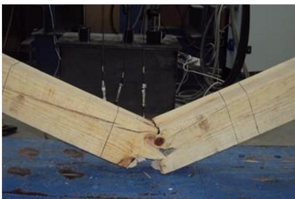
Figura 4.15 – Rotura da peça devido à presença de nós
