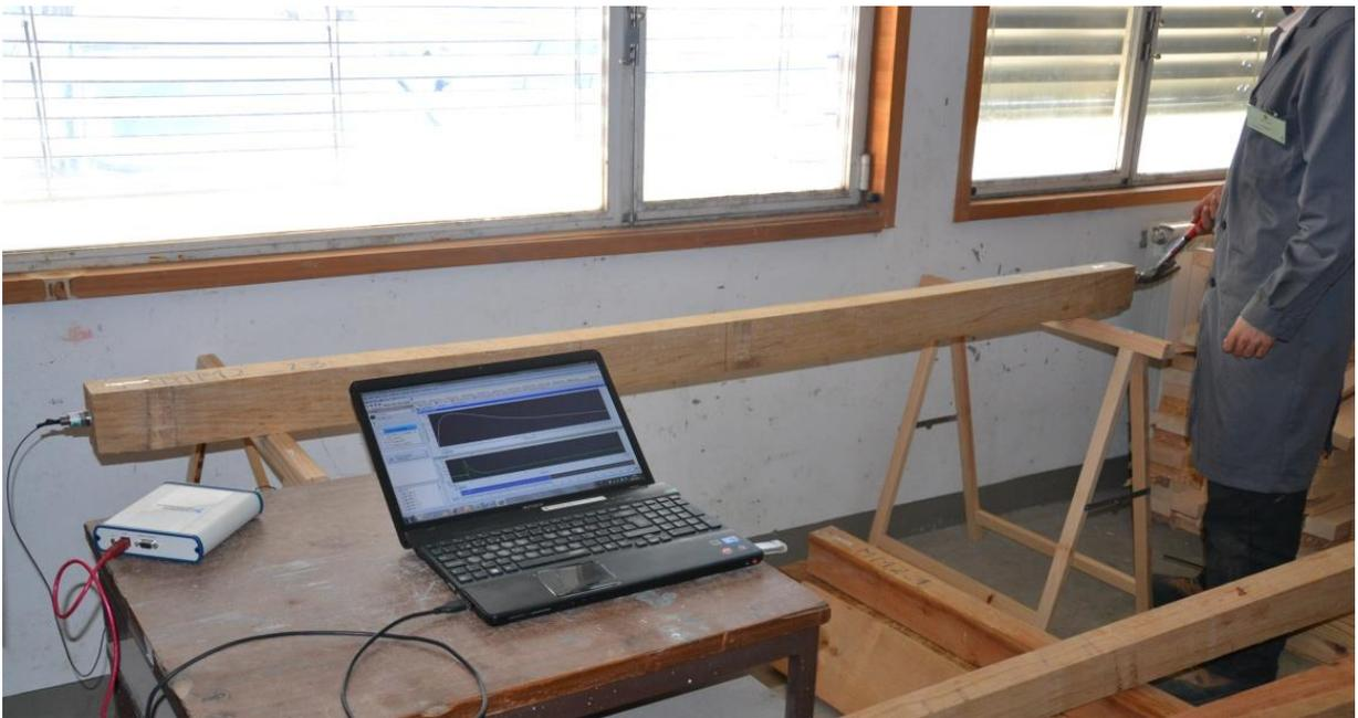
Figura 4.5 – Medição da frequência própria de vibração através do acelerómetro
