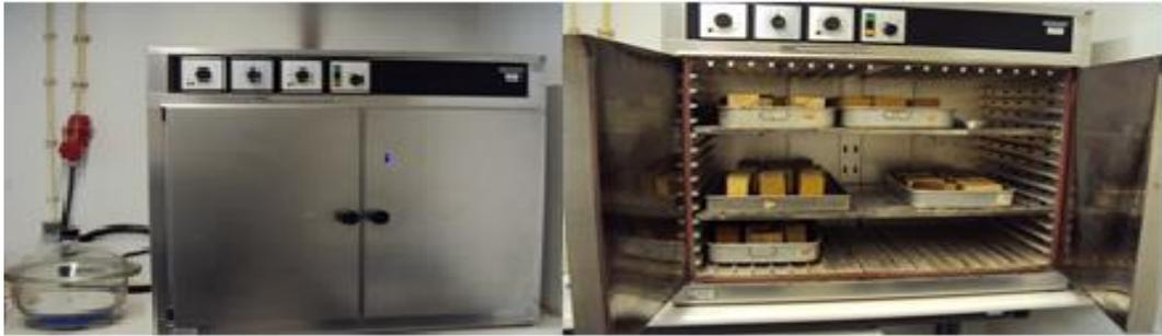
Figura 4.17 – Fornos para secagem dos provetes
