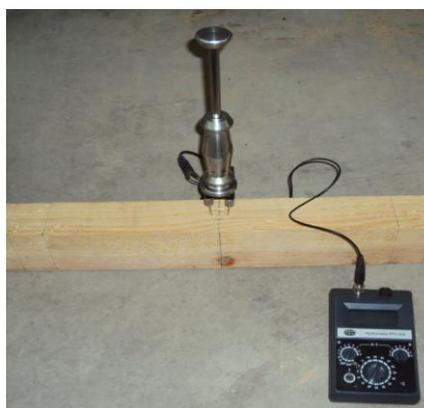
Figura 4.2 – Determinação do teor de humidade através de um humidímetro de agulhas
