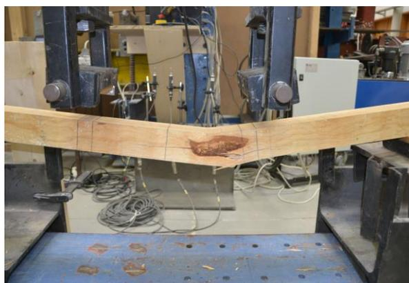
Figura 4.16 – Rotura da peça devido à presença de bolsas de resina
