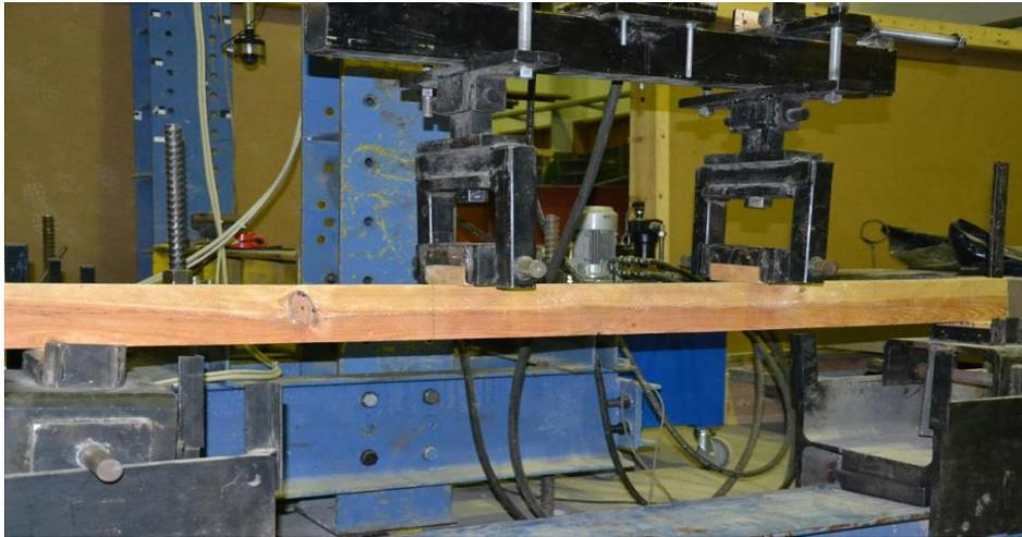
Figura 4.13 – Ensaio destrutivo para a determinação de  $f_m$
