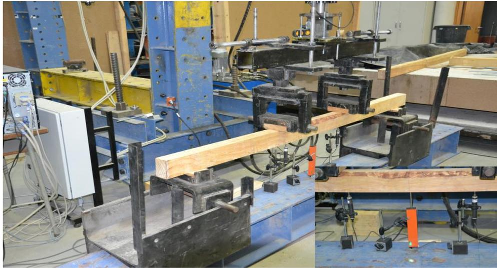
Figura 4.9 – Ensaio não-destrutivo para a determinação  $E_{m,local}$  e do  $E_{m,global}$ .
