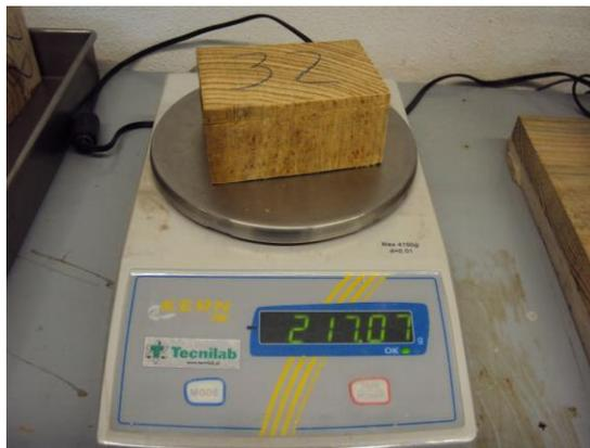
Figura 4.19 – Pesagem dos provetes
