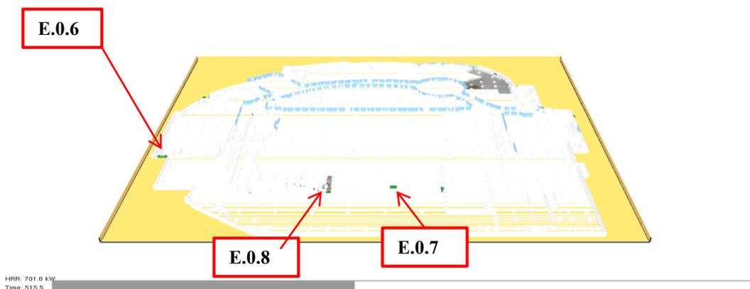
Figura 5.52 - Imagem da simulação de evacuação com incêndio do piso 0 na loja aos 515,5 segundos, cenário 3. (Fonte: Pyrosim, 2014)
