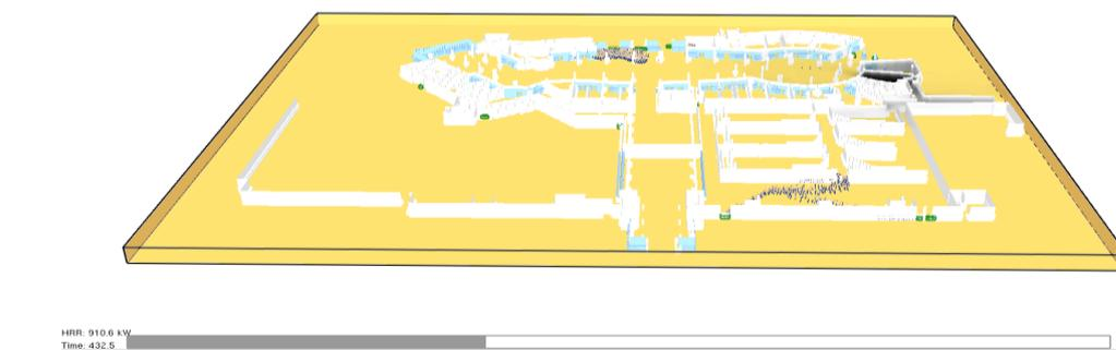
Figura 5.26 - Imagem da simulação de evacuação com incêndio do piso 2 aos 532,5 segundos, cenário 1. (Fonte: Pyrosim, 2014)
