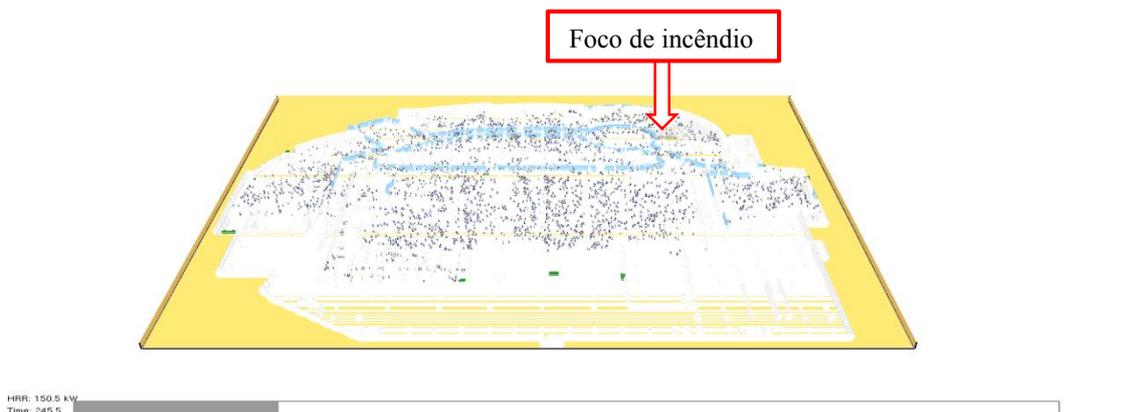
**Figura 5.50 - Imagem da simulação de evacuação com incêndio do piso 0 na loja aos 245,5 segundos, cenário 3. (Fonte: Pyrosim, 2014)**
