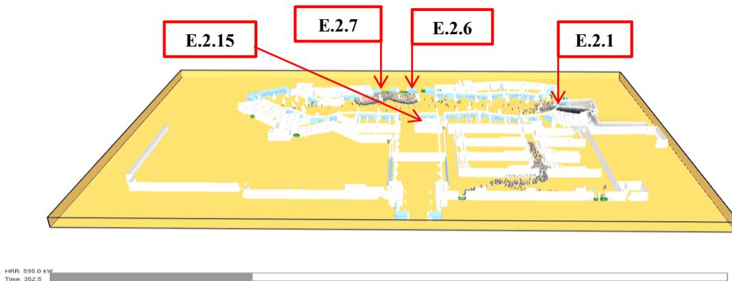
Figura 5.25 - Imagem da simulação de evacuação com incêndio do piso 2 aos 352,5 segundos, cenário 1. (Fonte: Pyrosim, 2014)
