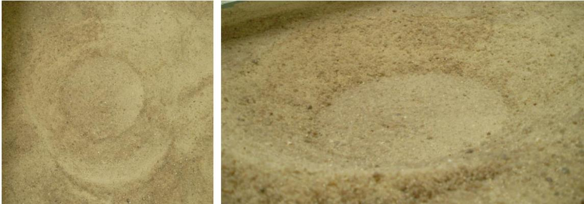
Figura 4.17 – Final do ensaio, após retirar a placa de carga.
