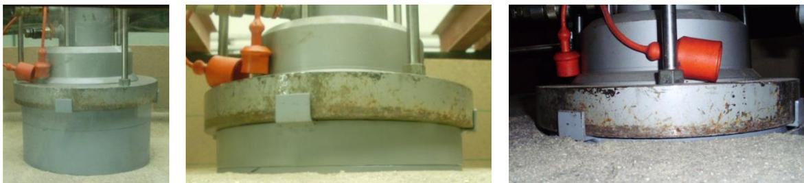
Figura 4.16 – Placa de carga com saia estrutural: sequência do ensaio.
