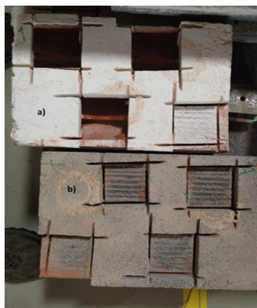
Figura 3.20: a) Rotura por coesão do suporte b) Rotura adesiva
