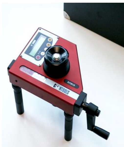
Figura 3.19: Equipamento utilizado para o ensaio “Pull-off”
