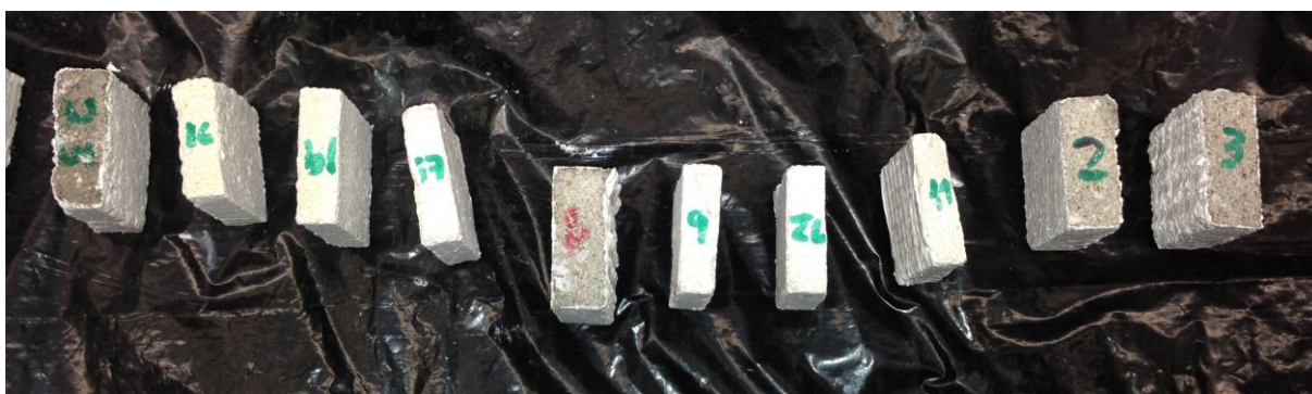
Figura 3.10: Parte dos provetes já impermeabilizados lateralmente
