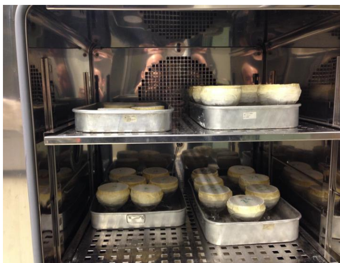
Figura 3.5: Conjunto tina/provete na câmara climática
