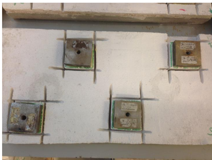
Figura 3.18: Pormenor do corte do suporte para a colagem das pastilhas metálicas
