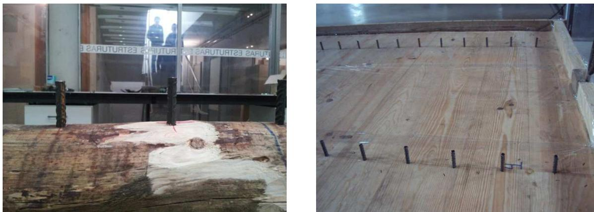
Figura 4.5 - Ligadores (à esquerda os toros; à direita laje mista madeira-betão)
