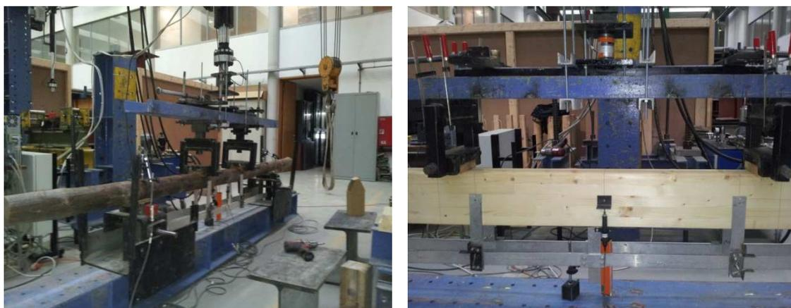
Figura 4.2 - Ensaio MOE dos elementos de madeira
