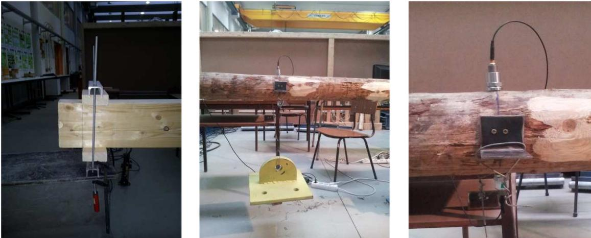
Figura 4.4 - Pormenores de ensaio (apoio encastrado, carga suspensa, acelerómetros)
