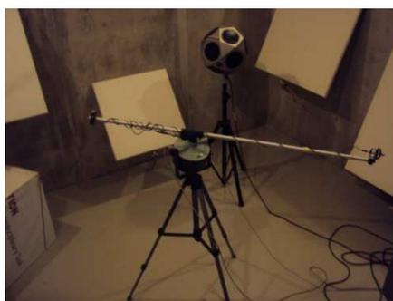
Figura 5.4 – Microfone móvel e fonte sonora na câmara receptora
