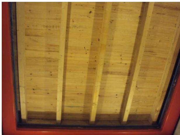
Figura 5.8 – Parte inferior da laje de madeira vista da câmara receptora
