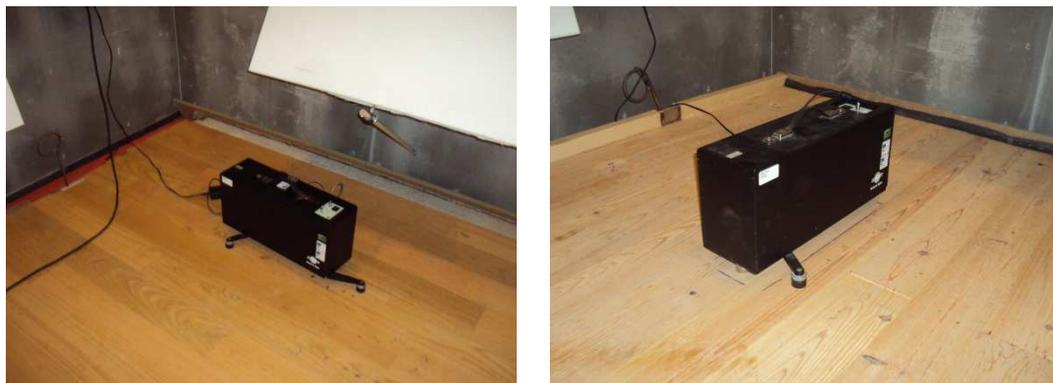
Figura 5.5 – Máquina de percussão (à esquerda sobre o flutuante de madeira, à direita sobre o soalho)
