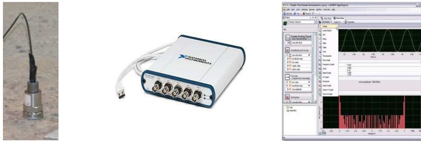
Figura 6.1 - Equipamentos de medição ( acelerómetro; módulo de aquisição; software)
