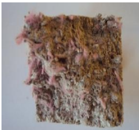
Figura 2.5 - Representação da aplicação de resíduos têxteis no reboco (Pinto et al., 2012)
