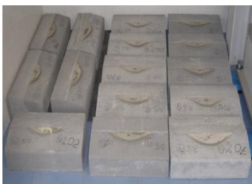
Figura 3.1 - Lancis fabricados a partir de agregados reciclados (Gayarre et al., 2011)
