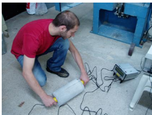
Figura 2.10 - Teste de condutividade (Issa e Salem, 2012)
