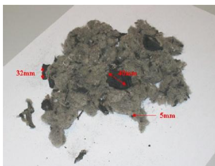
Figura 4.12 - Resíduos têxteis dos reforços dos pneus (Jimenez-Espadafor et al., 2010)
