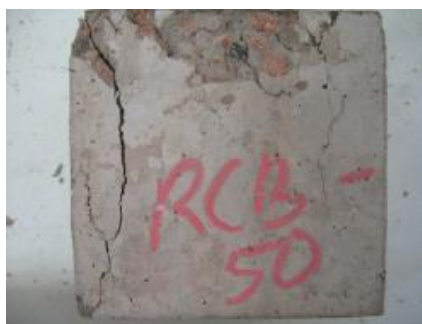
Figura 2.6 - Resíduos de betão e tijolos para fabrico de um novo betão (Yang et al., 2010)
