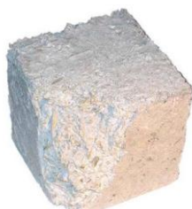
Figura 2.11 - Amostra de betão com agregados de madeira reciclada (Becchio et al., 2009)
