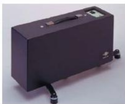
Figura 2.10 – Máquina de percussão normalizada (Tadeu et al. , 2010)
