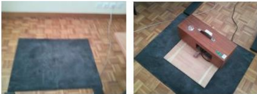
Figura 3.8 – Pavimento flutuante em madeira e aglomerado borracha
