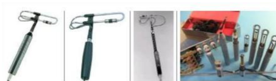
Figura 2.7 – Exemplos de sondas de intensidade (Tadeu et al. , 2010)
