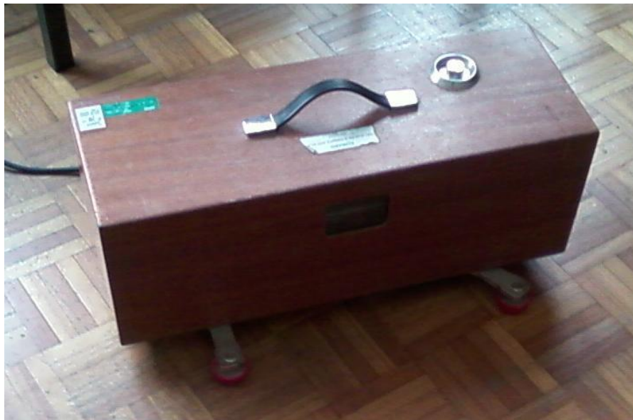
Figura 3.2 – Máquina de percussão utilizada nos ensaios in situ
