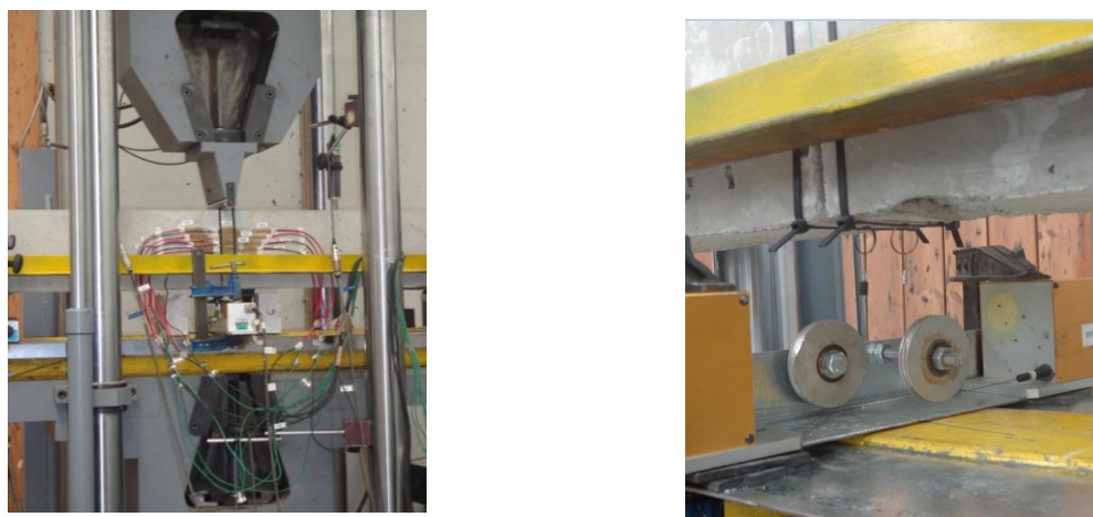
Figura A. 18 - Disposição dos defletómetros: (a) vista geral do ensaio e (b) pormenor dos defletómetros na zona inferior do ensaio.
