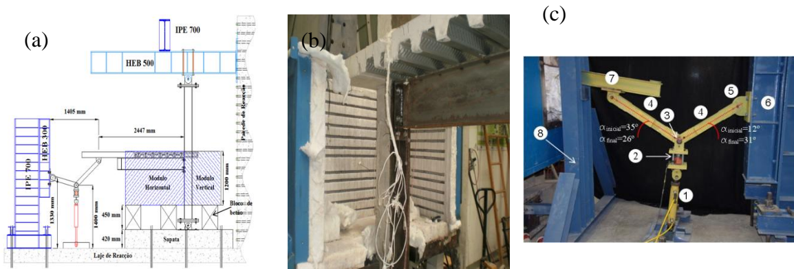
Figura 3.4 - Ensaio de ligações a temperaturas elevadas (a) esquema de ensaio; (b) pormenor do provete e (c) sistema de aplicação de carga nos ensaios E5 e E6 . (Barata 2010)
