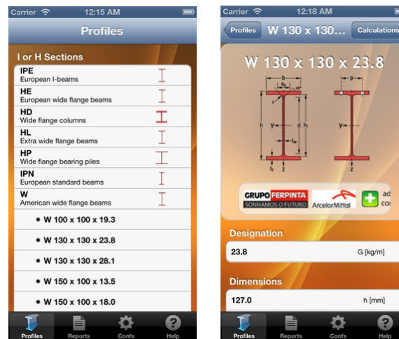
Figura 2.3 - Aplicação móvel de cálculo automático de acordo com o EC3-1-1
