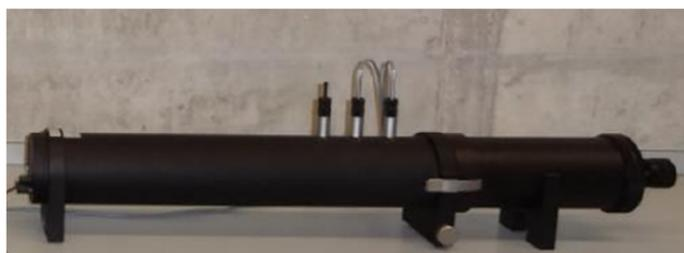
Figura 3.4 - Fotografia do tubo de impedância para a determinação da absorção sonora
