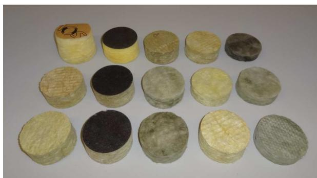
Figura 3.7 - Amostras de lã rocha, lã de vidro e lã mineral
