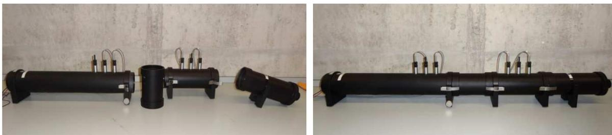
Figura 3.1 - Tubo de impedância decomposto (à esquerda); Configuração do tubo de impedância para a determinação do parâmetro de perda por transmissão sonora (à direita)
