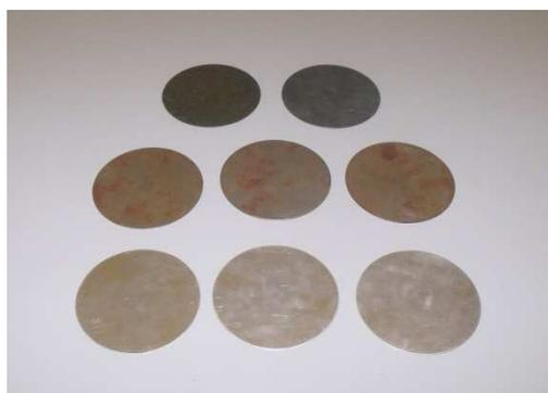
Figura 3.8 - Amostras de alumínio, aço e chumbo
