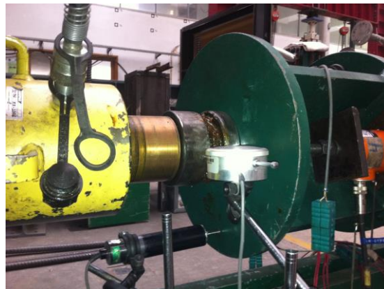
b) Pormenor da extremidade de aplicação de carga (secção S4)
