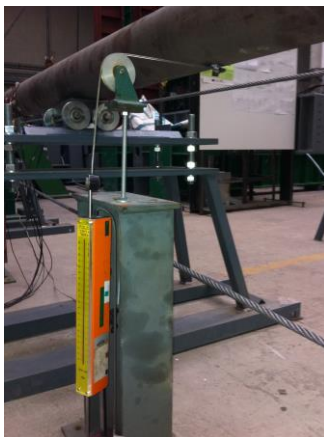
a) Disposição de LVDT numa secção de vão da coluna
