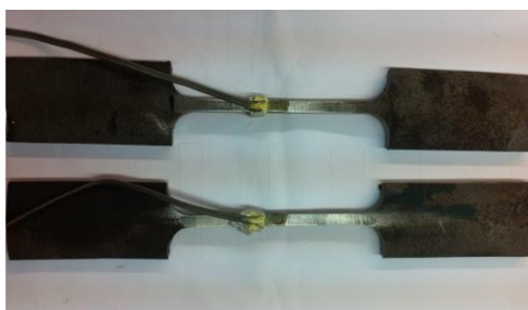
Figura 4.2 – Provetes instrumentados da COL03
