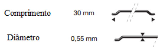
Figura 3.4 – Geometria das fibras Dramix RB305 (adaptado de Dramix, 2012)
