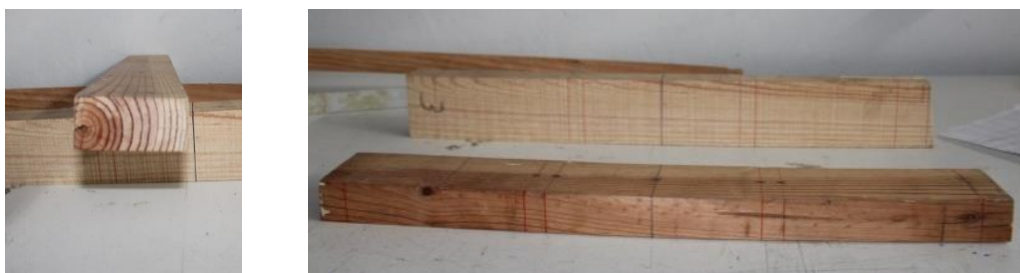
Figura 3.5 - Provetes de madeira serrada (vigotas)
