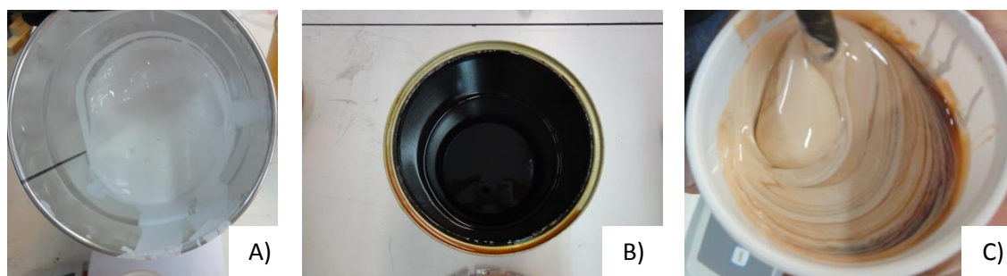
Figura 3.21 - Resina Icosit® K 101 TW, Sika ® AG: A) componente A; B) Componente B; C) mistura final (componente A+B)
