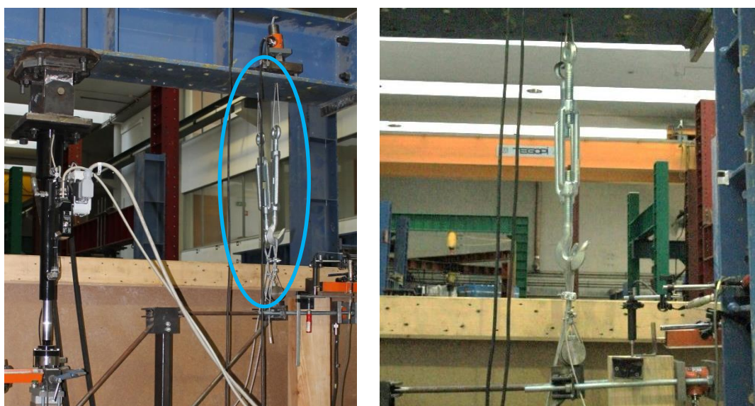
Figura 5.9 - Esticadores colocados nos cabos de ancoragem
