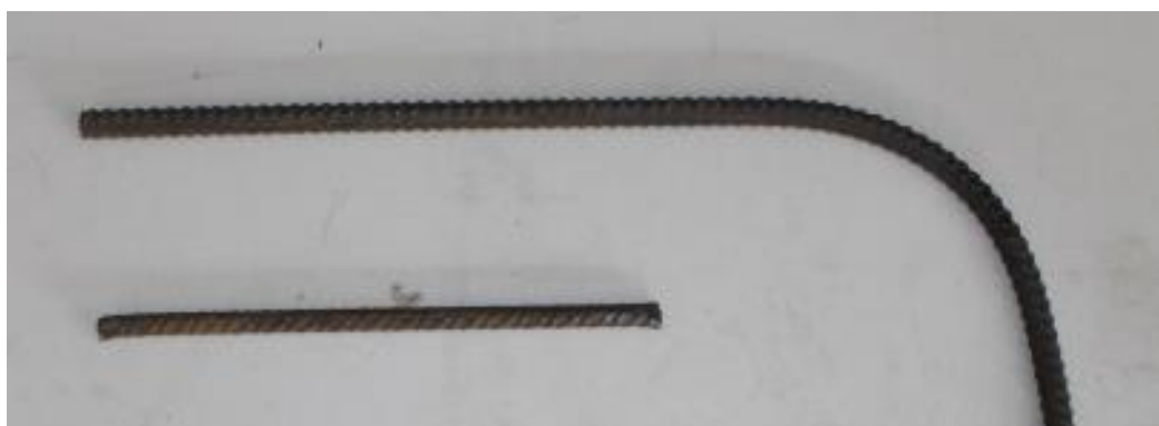
Figura 3.20 - Varões de aço nervurados da classe A400 NR
