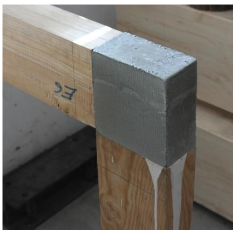
Figura 3.16 - Nó de continuidade em betão
