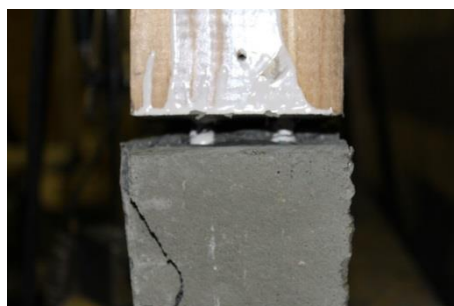
Figura 6.6 - Afastamento da zona de interface madeira-betão
