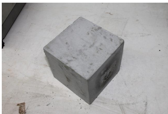
Figura 3.19 - Provede cúbico para ensaio de compressão aos 7 e aos 28 dias
