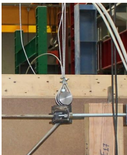
Figura 5.8 - Pormenor da ligação inferior do tirante vertical
