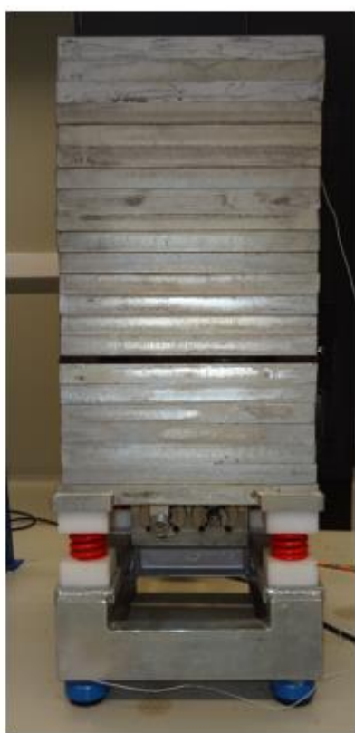
Figura 3.12- Provete com carregamento M15: a) vista global; b) deformação do provete.
