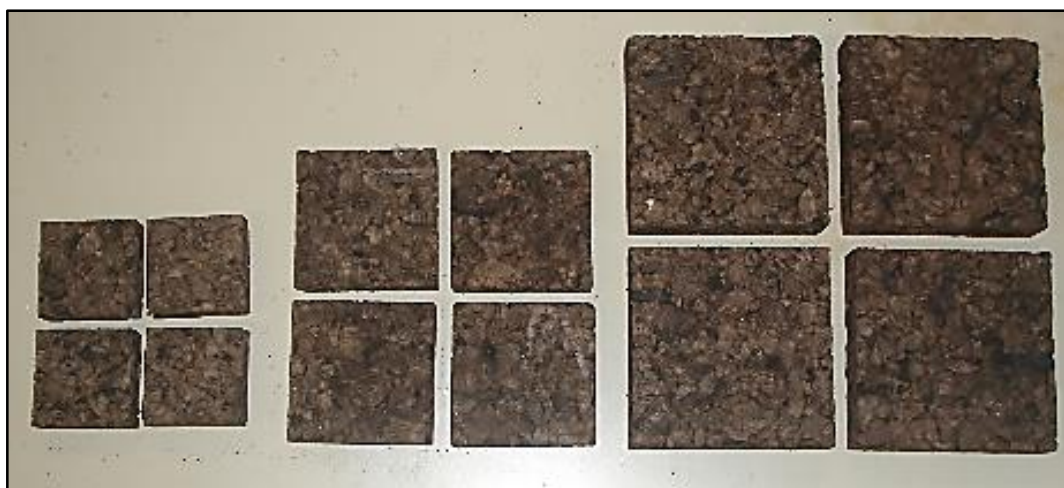
Figura 3.10 - Amostras com 225 cm 2 , 450 cm 2 e 900 cm 2 (da esquerda para a direita).
