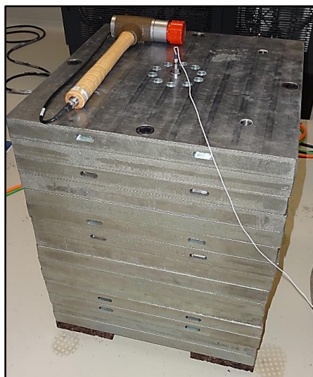
Figura 3.7 – Equipamento de ensaio para determinar o fator de amortecimento.
