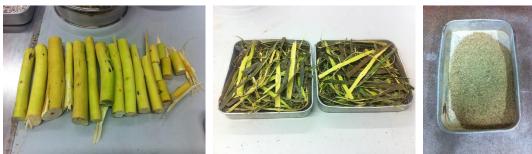
Figura 3.1 - Processo de transformação das fibras de acácia.
