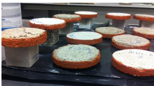
Figura 3.7 – i) Impermeabilização das faces laterais dos provetes; ii) Sistema tina-provete.
