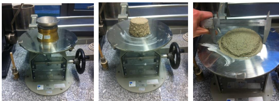
Figura 3.3 – Realização do ensaio de consistência por espalhamento.
