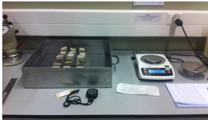
Figura 3.9 – Medição da massa dos provetes colocados no tanque de água.
