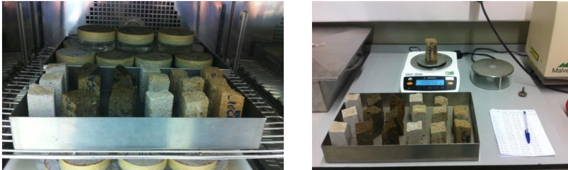
Figura 3.12 – i) Colocação dos provetes em estufa; ii) Medição da massa de cada provete
