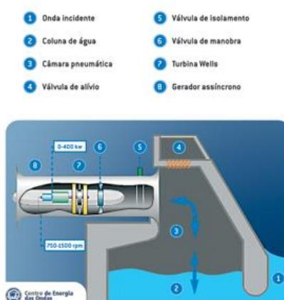
Figura 2.7 - - Modelo da coluna de água oscilante utilizado no projeto “Pico Plant”. (SPPP, 2014)
