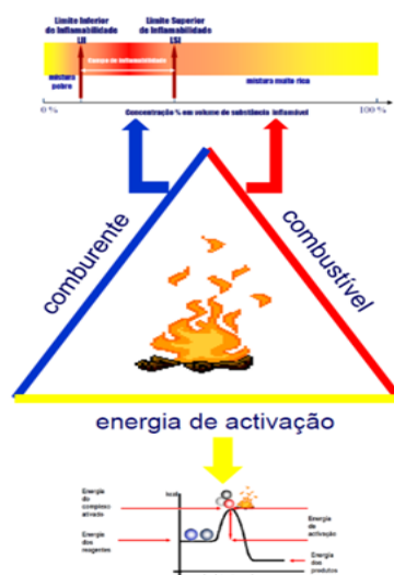
Figura 7 - Condições necessárias para a combustão.
