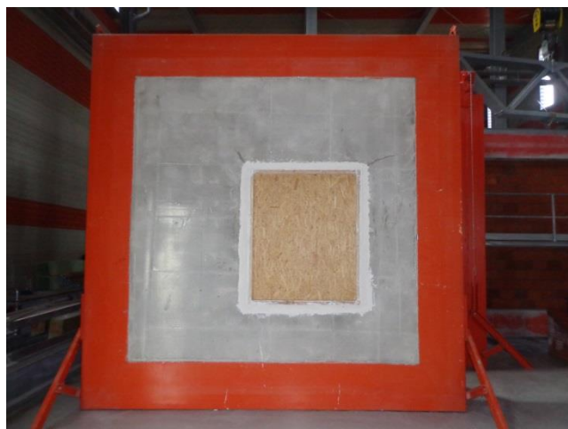
Figura 3.6 – Aro pré fabricado utilizado nos ensaios de isolamento a sons aéreos.
