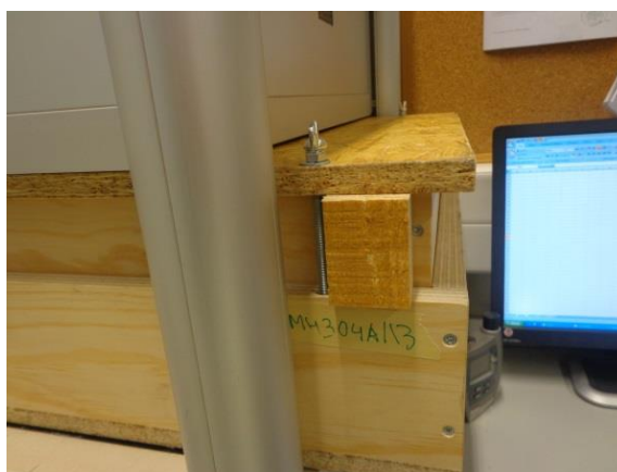
Figura 3.5 – Pormenor de calço que permite garantir a espessura do provete constante.
