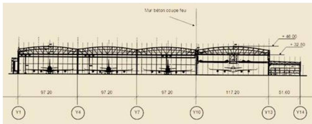
Figura 3.8 - Pórticos treliçados do hangar da Airbus em Toulouse, França. Fonte: Cabinet Jaillet-Rouby, France (2013)
