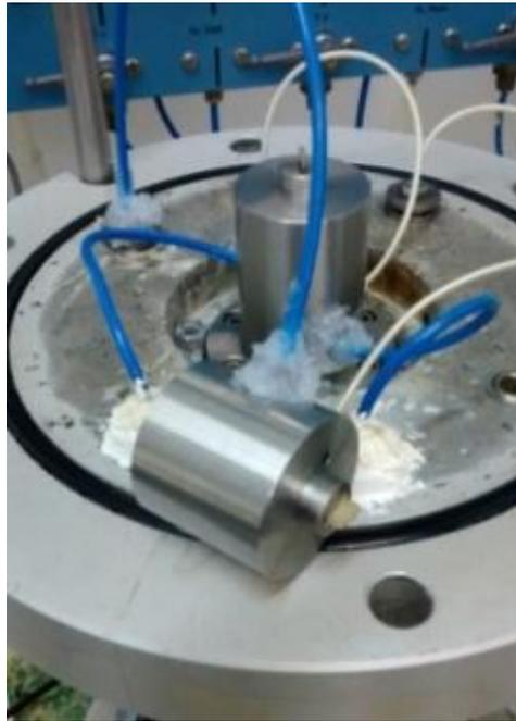
Figura 2.9 - *bender elements* utilizados nos ensaios realizados.
