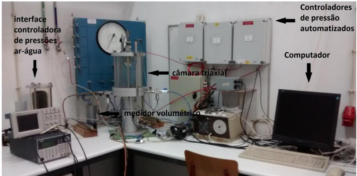
Figura 3.7 – Célula triaxial e equipamentos inerentes ao seu funcionamento.
