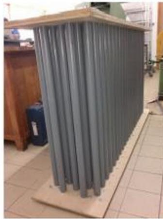
Figura 2.9 - Protótipo da barreira acústica de cristais sónicos usado na conceção do ensaio (Martins et al, 2013)
