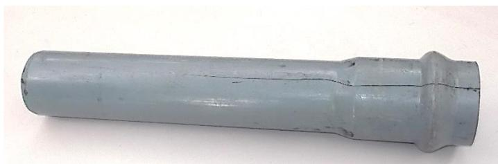
Figura 3.15 – Conduta em PVC com uma fenda.
