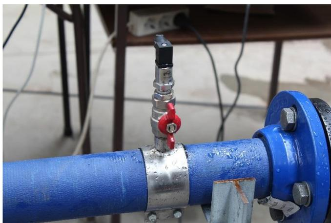
Figura 3.4 – Transdutor de pressão do tipo piezoelétrico.
