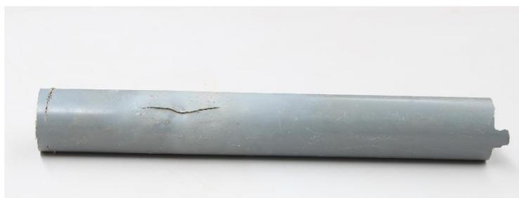
Figura 3.16 – Conduta em PVC com uma fenda de 8 cm.
