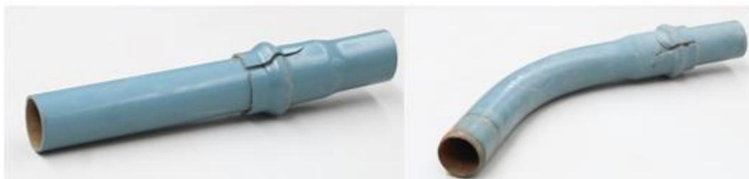
Figura 3.17 – Fugas e roturas que resultaram de uma fenda na junção de duas condutas
