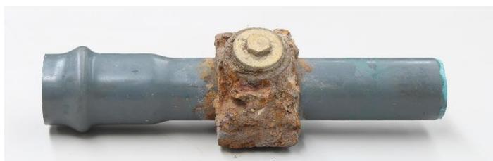
Figura 3.14 - Fuga que originou corrosão na tomada de água.
