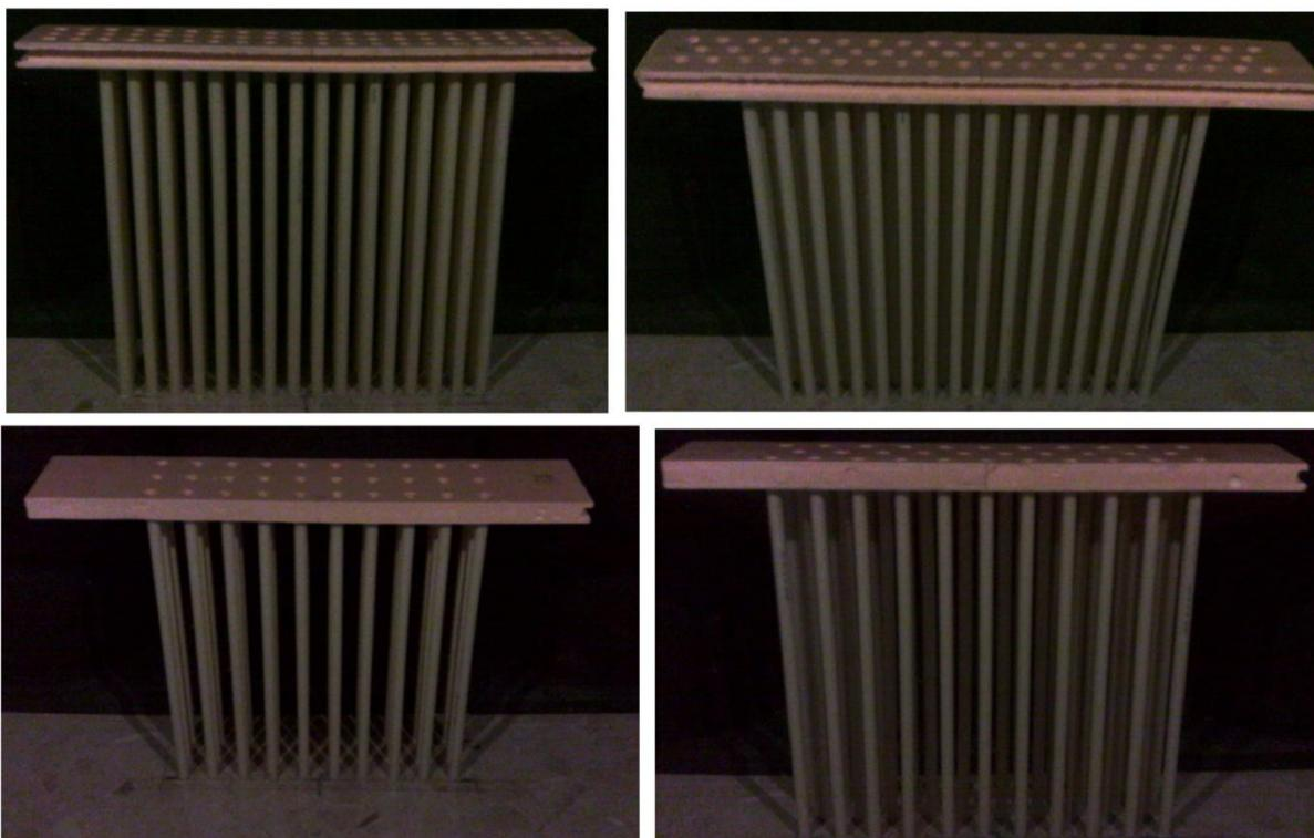
Figura 5.2 – Em cima à esquerda cristal sônico retangular  $2xd$ , à direita em cima cristal sônico triangular  $2xd$ , em baixo à esquerda cristal sônico retangular  $3xd$  e à direita em baixo cristal sônico triangular  $3xd$
