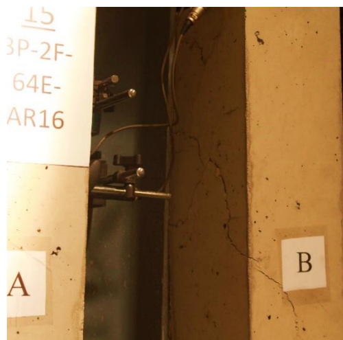
b) Modo de rotura intermédio - Ensaio 15
