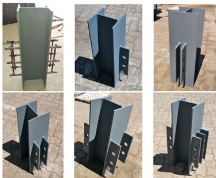
Figura 4.1- Provetes metálicos utilizados. Em cima, da esquerda para a direita: S-3x2, P-1F, 2P-2F-30E. Em baixo, da esquerda para a direita: 2P-2F-85E, 2P-2F-140E, 3P-2F-64E.
