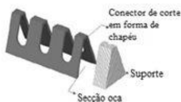
Figura 2.11- Conectores do tipo “Hat” (Kim et al , 2011)
