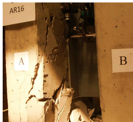
b) Modo de rotura final - Ensaio 16
