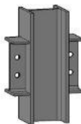
Figura 2.19- Conector do tipo I-Perfobond (Figueiredo, 2012)
