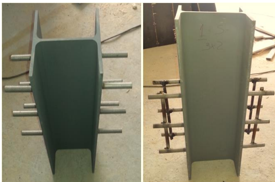
Figura 4.2- Conector tipo Stud . À esquerda na fase inicial, à direita após a solda do varão \varnothing 10 entre os varões roscados
