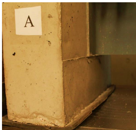
a) Modo de rotura final - Ensaio 10: laje A
