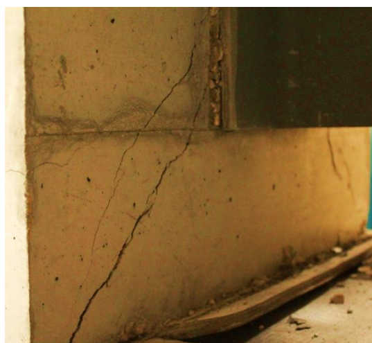
a) Modo de rotura intermédio - Ensaio 12
