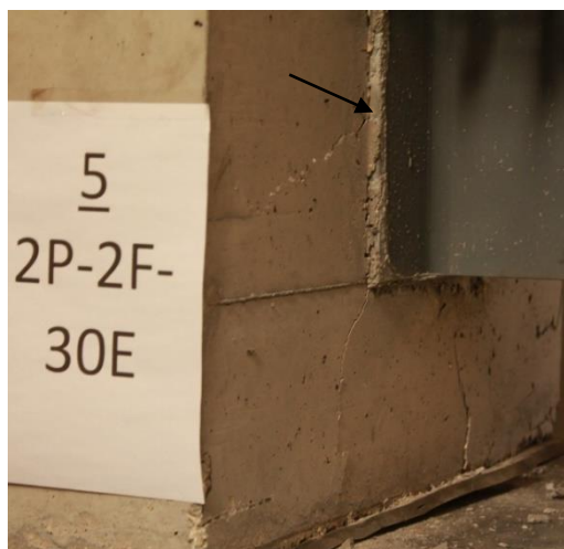
a) Modo de rotura intermédio - Ensaio 5
