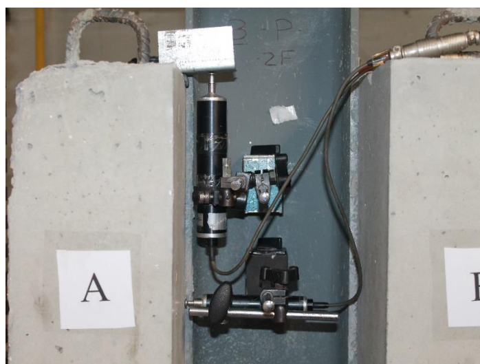
Figura 4.9-Ilustração dos LVDT's numa das faces do provete
